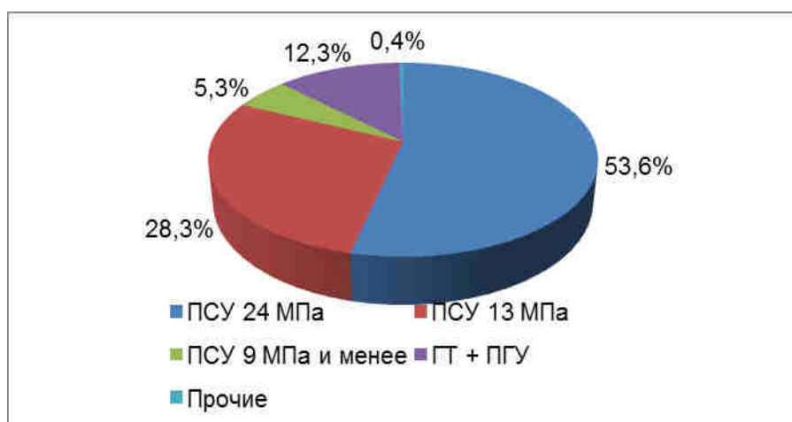
Рисунок 1.3 — Структура генерирующих мощностей КЭС с разбивкой по параметрам и составу оборудования
